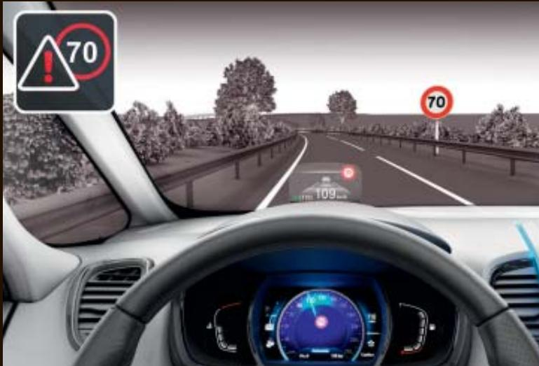
**Alerta de exceso de velocidad con reconocimiento de señales de tráfico.** El sistema permite adaptar la conducción en función de los datos de la señalización captados por la cámara del vehículo. La alerta visual es infalible gracias al sistema "Head-up display".
